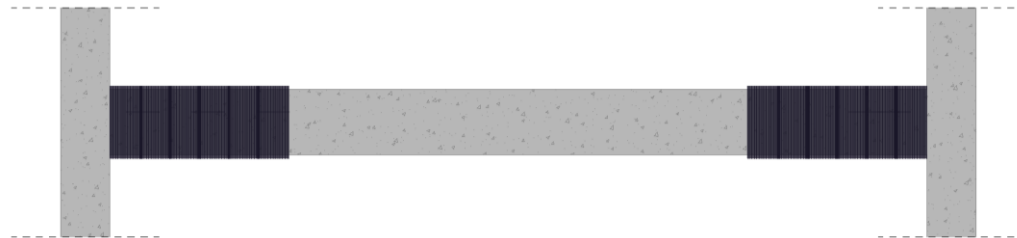
RINFORZO A TAGLIO CON AVVOLGIMENTO CONTINUO
