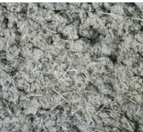
Fibre disperse nella matrice cementizia
