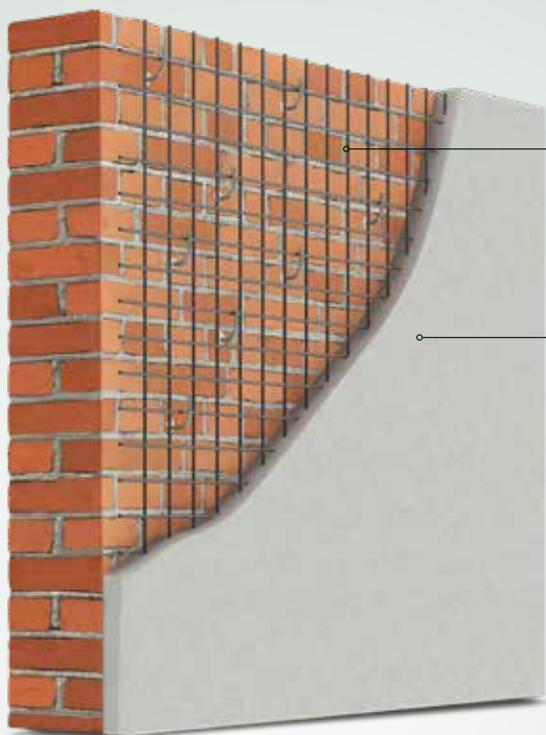
Rete elettrosaldata in acciaio zincato o inox
