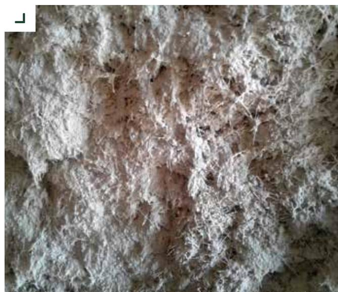
Dettaglio delle fibre in PLANITOP INTONACO ARMATO
