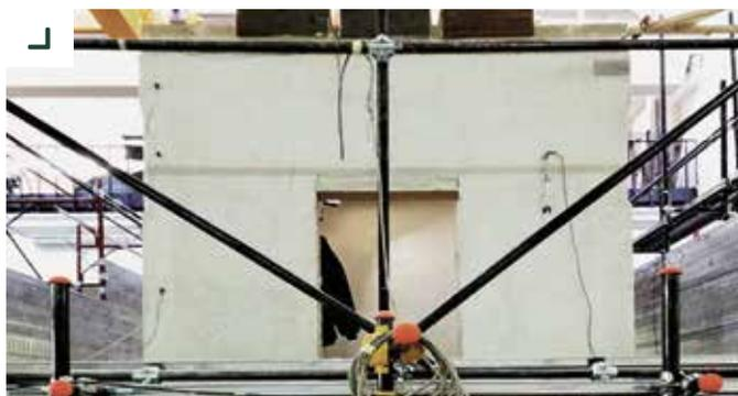
Progetto METRICS (METodologie e Tecnologie per la gestione e Riqualificazione dei Centri Storici e degli edifici di pregio) DISTRETTO STRESS - Sperimentazione su tavola vibrante di edificio in muratura, in scala 1:2
