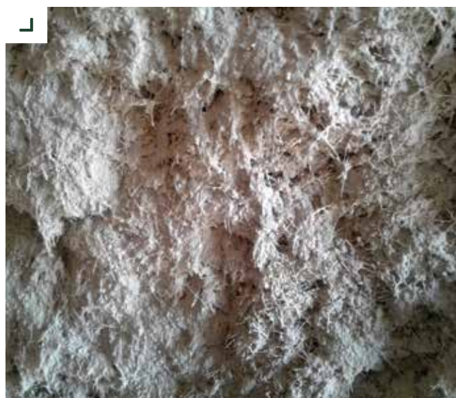
Dettaglio delle fibre in PLANITOP INTONACO ARMATO
