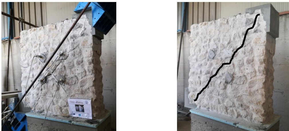
Figura 5. Tipica rottura diagonale del pannello non rinforzato
